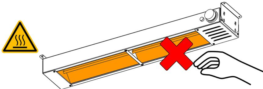
**Distanze minime dalle superfici sensibili al calore o infiammabili da prevedere durante l'installazione**
