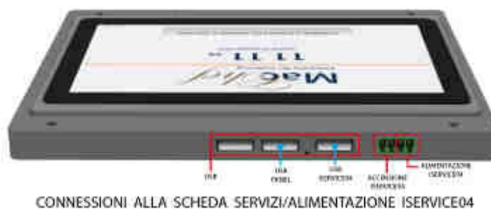
Nella parte superiore del controllo ci sono due connettori per collegarsi al circuito servizi. Come da immagine sopra, da sinistra, le prime tre connessioni ( USB ) si riferiscono alla presa per il connettore USB da pannello e allo scambio dati con la scheda ISERVICE04, mentre ne resta una libera, per altri utilizzi. La successiva connessione sempre da immagine sopra, ( verde ) è la presa da collegare alla scheda servizi, ISERVICE04, per l'accensione del controllo e l'alimentazione.
