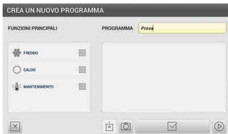
La videata “Crea un nuovo programma” consente di comporre le funzioni in successione da eseguire, con i parametri desiderati. Le funzioni sono “FREDDO – CALDO – MANTENIMENTO”. La funzione “CALDO” è disponibile solo sulle macchine dotate di sistema di riscaldamento.
