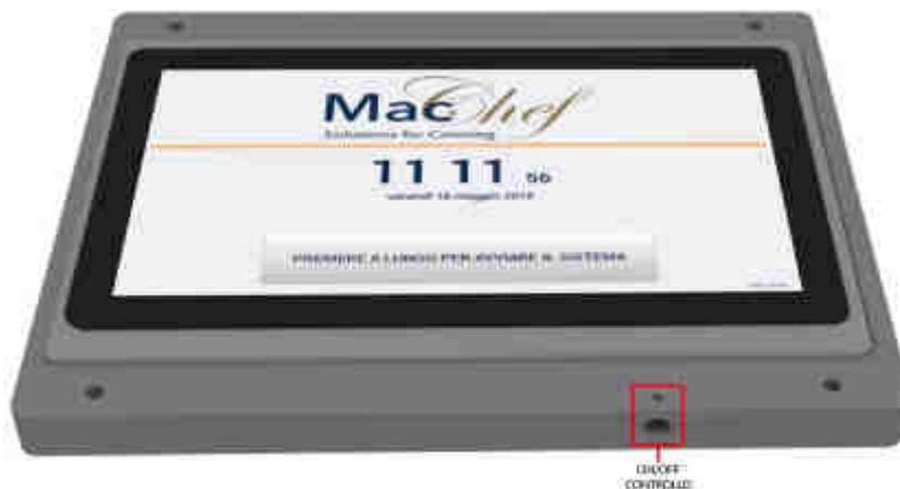
Nella parte inferiore del controllo a destra come da immagine sopra vi è un pulsante di ON/OFF del controllo. L'accesso è possibile anche dalla parte frontale del pulsante ON/OFF per mezzo di un foro. Questo comando è da considerarsi di emergenza, in caso si dovesse riavviare/spegnere il controllo, poiché normalmente, è gestito direttamente dalla scheda servizi, ISERVICE004.
