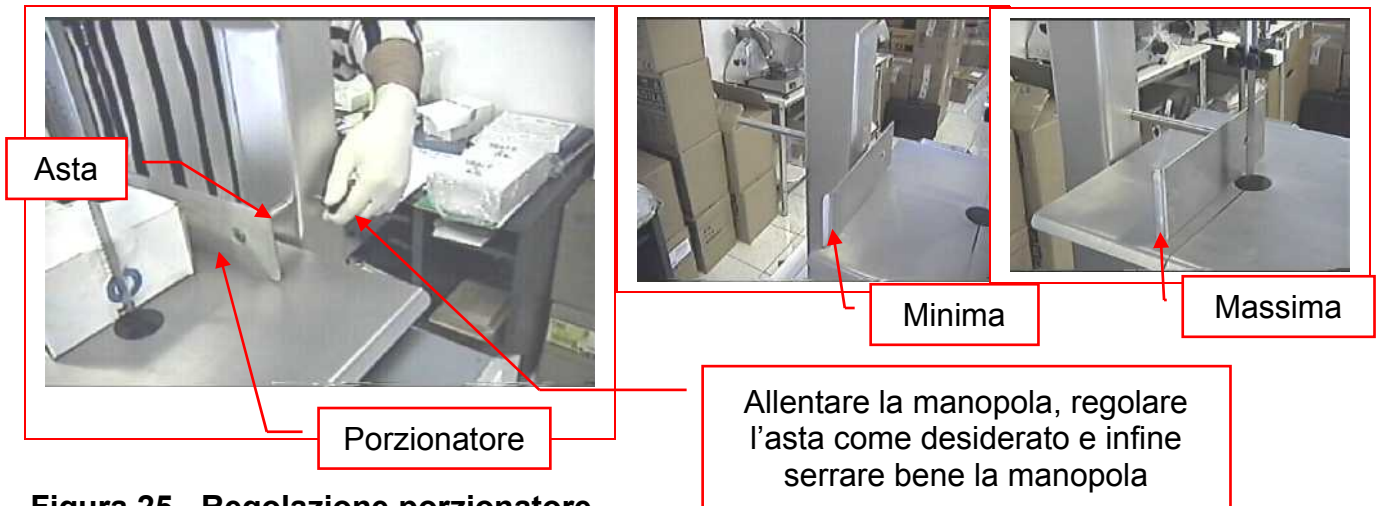
Figura 25 - Regolazione porzionatore
