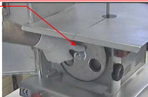
Figura 23 - Regolazione inclinazione puleggia superiore
