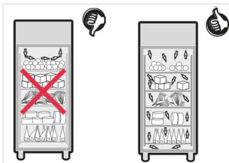
Per il corretto funzionamento dell'armadio refrigerante, è necessario che i prodotti contenuti siano disposti in modo da non ostacolare la libera circolazione dell'aria refrigerata all'interno del mobile stesso.
