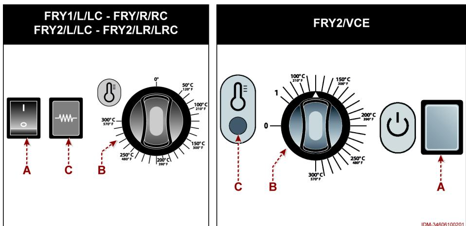
**A)** Interrupteur général: sert à enclencher ou couper le fonctionnement de l'appareil.
